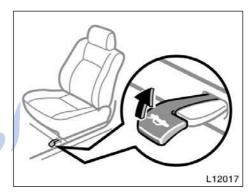
To open the trunk lid from the driver's تلفن شبانه روزی: ۱۵۸۰۲۹۸۸ میانه seat, pull up on the lock release lever.
