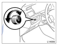
To adjust the brightness of the instrument panel lights, turn the knob. الفن شبانه روزی: ۱-۸۸۸۶۲۰۸۵ تلفن شبانه روزی
