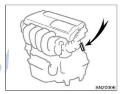
The engine number is stamped on the engine block as shown. تلفن شبانه روزی: ۱۹۸۸×۲۲۸۸۸ تلفن
