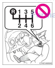
تلفن شبانه روزی: ۱۸۸ م Do not shift the shift lever without depressing the clutch pedal.
