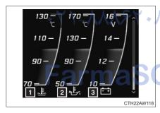
I Engine coolant temperature gauge تلفن شبانه ر
