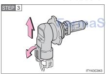
تلفن شبائه روزی: ۵۵ Unplug the connector while pulling the lock release.
