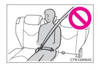
N'utilisez pas la ceinture de sécurité du siège central de deuxième rangée si l'une des 2 boucles est déverrouillée.
